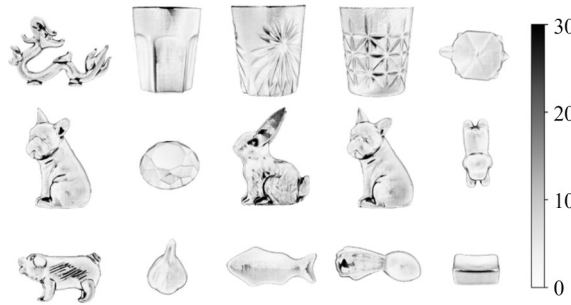
图 14 本文方法在 ThermoPol16 数据集中各样本的法向量角度误差分布 Fig. 14 Angular error maps of normals vectors for test samples on ThermoPol16 dataset using proposed method
